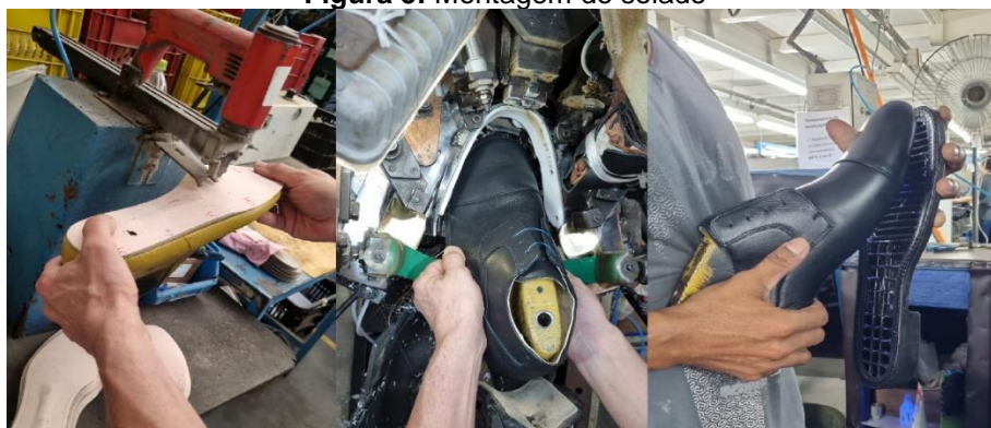
Figura 5: Montagem do solado
