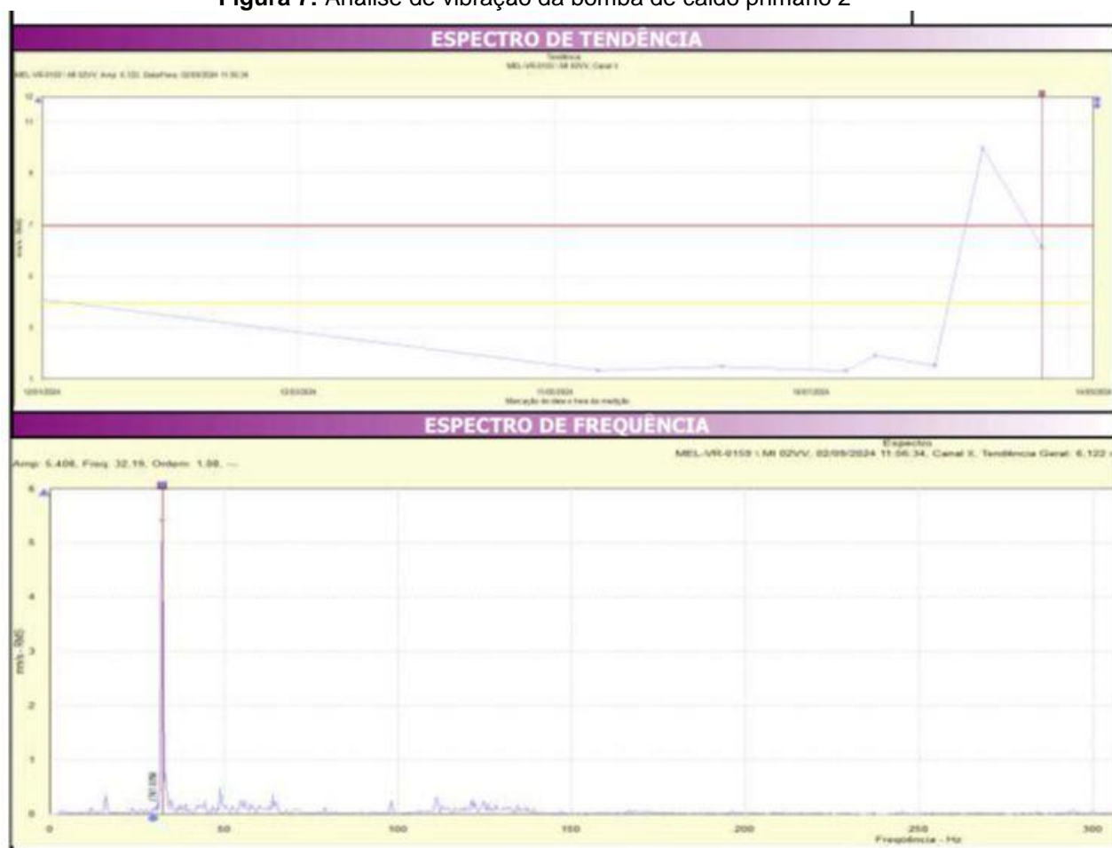
Figura 7: Análise de vibração da bomba de caldo primário 2
