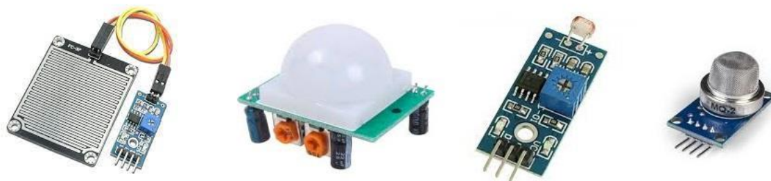
Figura 3 – Sensores utilizados neste protótipo
