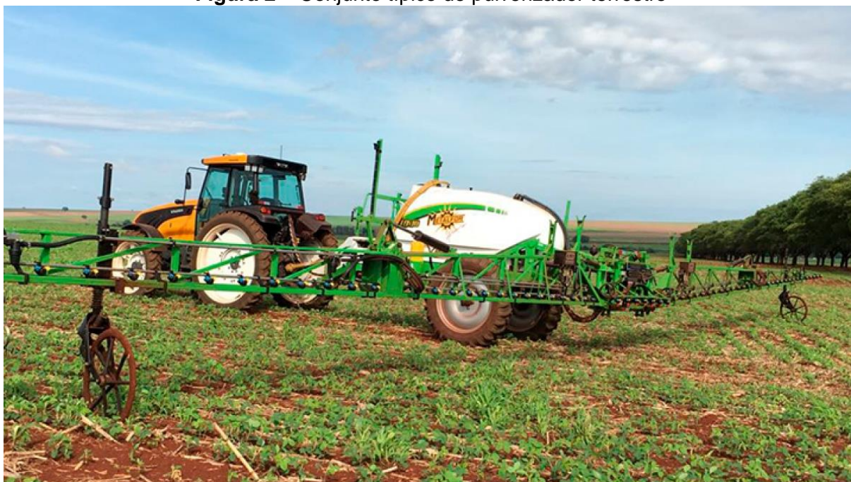
Figura 2 – Conjunto típico de pulverizador terrestre
