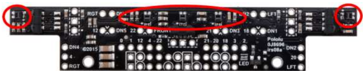
Figura 7 - Matriz de Sensores Frontais do Zumo 32U4
